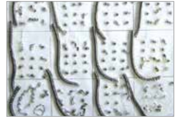
Concurrent B Copeaux pliés sous certaines conditions de coupe. Mauvaise évacuation des copeaux.
