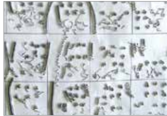
Concurrent A Les copeaux fins et longs sont enroulés autour du support.
