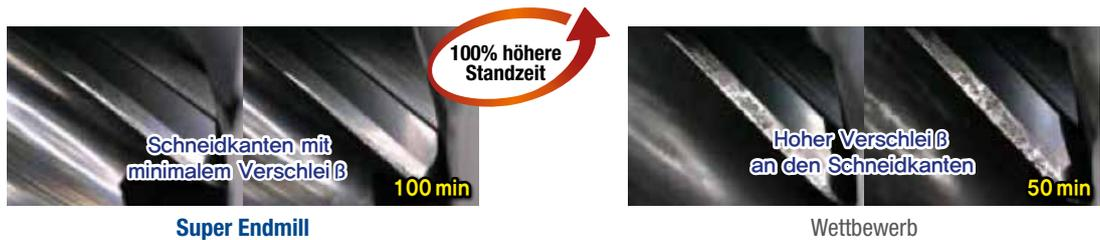
► **Höchste Zerspanleistung durch hochzähes Substrat**
