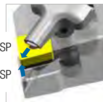
Richtung der Kühlmittelzufuhr
